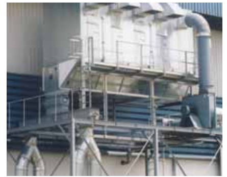
ตู้ NFK แบ่งการจัดเก็บฝุ่นจาก คอนเทนเนอร์หนึ่งในสองตู้ ที่เชื่อมติดกันผ่านทางสายพานลำเลียง
