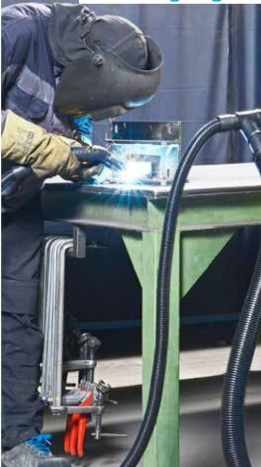
Die Erfassung an der Quelle geschieht oft durch freistehende, bewegliche Hauben, allerdings müssen diese häufig neu ausgerichtet werden. Eine alternative Möglichkeit für das MIG/MAG-Schweißen ist die **Absaugung am Schweißbrenner**.
