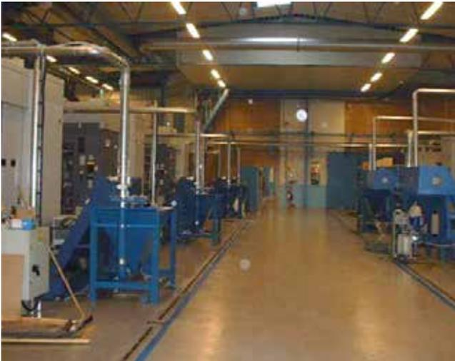
*Im Bereich der zerspanenden Industrie können diese Hochvakuum-Saugsysteme zur Reinigung von Maschinen und dem Transport von Metallspänen (trocken und feucht) eingesetzt werden.*
