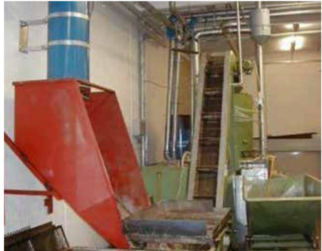
*An einem zentralen Sammelpunkt werden die abgesaugten Späne abgeschieden und einem Sammelcontainer oder einer Späneaufbereitung zugeführt.*
