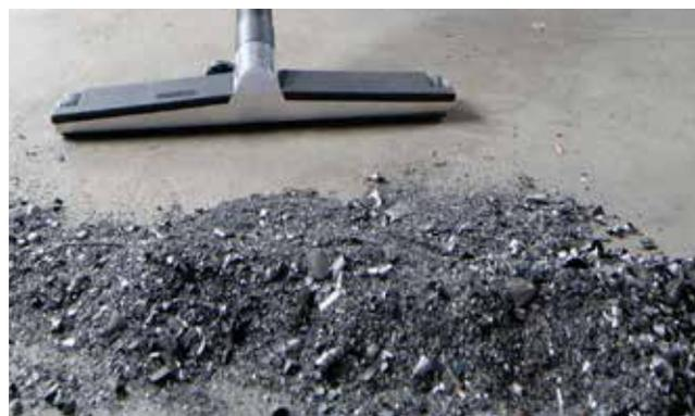
*Die Erfassung der Späne oder auch Flüssigkeiten erfolgt in der Regel manuell von Hand direkt an den Bearbeitungsmaschinen mittels verschiedener Erfassungsdüsen.*
