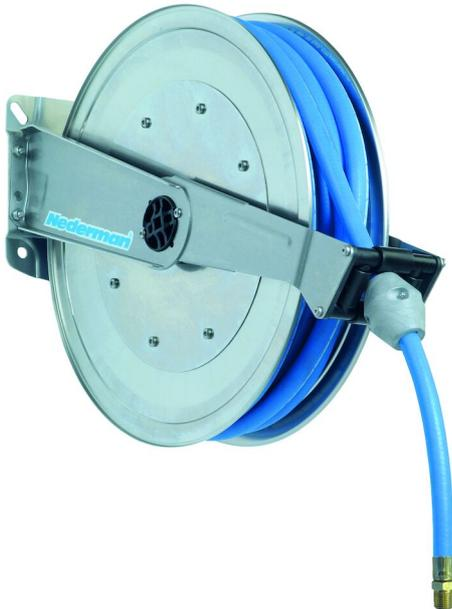
Les enrouleurs de tuyau anticorrosion disposent d'une platine en inox, d'un moyeu et d'un raccord pivotant en laiton, et d'un tambour en matériaux composites.
