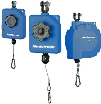
El equilibrador soporta la herramienta o la manguera y la mantiene elevada todo el tiempo. Un freno centrífugo integrado previene que el tensor pueda recoger demasiado rápido, lo que minimiza el riesgo de daños sobre personas. Disponible en tres modelos y nueve tramos de peso, de entre 0,5 kg a 10,9 kg.
