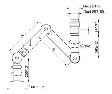
• FX2-ESD/EX-D75-L1100-Up-Low Numéro de pièce: 70603944 Max. rayon d'action: 1090 mm (42,9 in) A: 420 mm (16,5 in) B: 420 mm (16,5 in)
