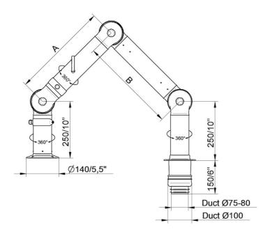
• FX2-ESD/EX-D75-L1100-Down-Through Numéro de pièce: 70604244 Max. rayon d'action: 1090 mm (42,9 in) A: 420 mm (16,5 in) B: 420 mm (16,5 in)
