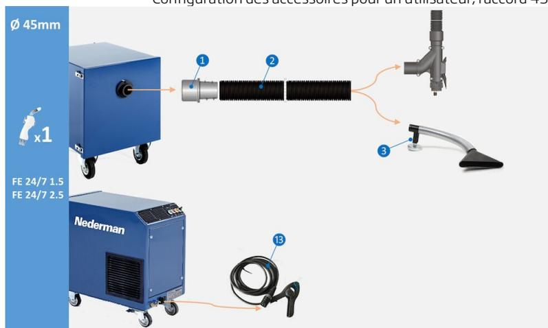
Configuration des accessoires pour un utilisateur, raccord de machine à souder 45 mm. (1) Raccord de tuyau M50-44P, réf. 55999418 (2) Tuyau Superflex Ø45 mm noir 5 m, réf. 55999411 (3) Buse entonnoir TM-200, réf. 55999413 (13) Fixation de capteur avec fiche pour départ/arrêt automatique, réf. 55999410
