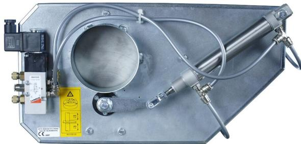
Die Ventile TAV 100 und TAV 150 kommen vorrangig als Absperrventile in den Hauptabzweigen des Rohrleitungssystems zur Anwendung. Diese Ventile öffnen und schließen automatisch und somit konzentriert sich der Unterdruck stets an den Anschlüssen, Explosionspunkten oder den aktuell betriebenen Maschinen. Dies trägt zu maximierter Saugleistung, sinkenden Betriebskosten und einer kompakten Bauweise der Vakuumeinheit bei.
