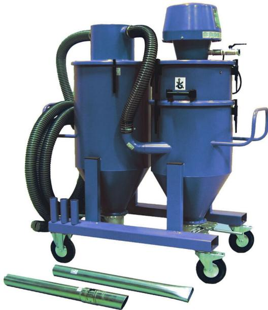
Aspirador industrial potente e flexível instalado em carro, equipado com uma unidade de descarga de grossos/poeira em silo pré-separador. O grão aspirado pode ser descarregado para um saco, sistema de alimentação ou contentor. A poeira fica retida no filtro NFC e é recolhida no segundo silo. Adequado para uso em cabines de decapagem para a recuperação da granalha e de limpeza de cascos e estruturas de aço.
