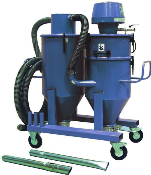
Мощный и универсальный промышленный пылесос, установленный на тележке, снабженный устройством для песка / пылеудаления на силосе предварительного сепаратора. Очищенный абразив (грит) можно опорожнить в контейнер, систему загрузки или мешок. Пыль улавливается на фильтре NCF в контейнере второй ступени. Подходит для использования в цехах дробеструйной обработки для рекуперации абразива, очистки обрабатываемых изделий и стальных конструкций.
