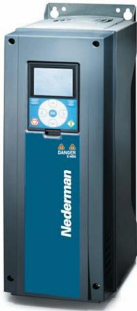
Control de frecuencia para mantener la presión constante del sistema. El Nederman Fan Inverter es un controlador de frecuencia que está preprogramado con una aplicación de extracción para los aspiradores Nederman. Está equipado con un sensor de presión y un controlador PID que permite mantener una presión negativa constante en un sistema de extracción.
