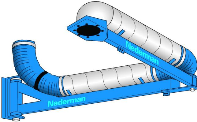
Der Nederman Verlängerungsarm 4.2m ist für die Nederman Absaugarme entworfen wenn eine zusätzliche Erfassungsreichweite benötigt wird. Eine stabile Wand-Schwenkkonsole ermöglicht in Verbindung mit einem Knickgelenk eine maximale Schwenkbewegung und Beweglichkeit. Der Verlängerung wird aus stabilen Vierkant-Stahlrohren hergestellt. Der Anschluss kann in Kombination mit einer zentralen Absaugung oder als Einzelplatzlösung erfolgen.
