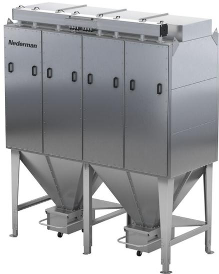
MCP SmartFilter это многоцелевая фильтрующая система. Она может быть сконфигурирована так, чтобы идеально подходить под конкретные требования заказчика, с воздушным потоком до 28 000 м<sup>3</sup>/ч. Применяется для туманов, дымов, пыли, и может быть использована в различных сферах применения таких, как сварка, резка металла, и для обычной общепромышленной пыли.
