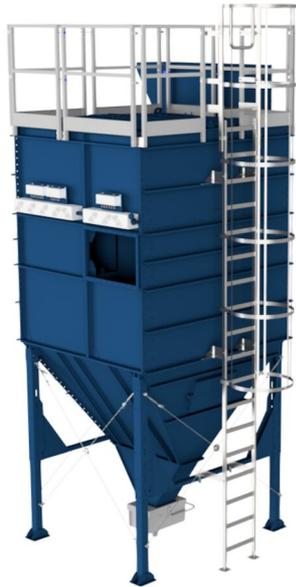
O LBP SmartFilter EX é um filtro de bolsas redondas projetado para operação contínua em muitas indústrias, para vários tipos de processos e poeiras, incluindo poeiras combustíveis. É personalizável para atender aos requisitos específicos do cliente, com três comprimentos diferentes de bolsas, área filtrante até 266m<sup>2</sup> e caudal de ar até aproximadamente 30.000 m<sup>3</sup> / h (dependendo das características da conduta).
