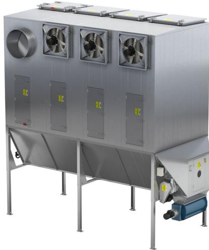
Le modèle LBR-C est un système de filtration avancé, prêt pour l'IOT, adapté aux applications d'air à volume élevé continu et de poussière lourde. Le système de filtre modulaire peut être assemblé pour une application correcte et des modules supplémentaires peuvent être installés sur le terrain si une capacité supplémentaire est nécessaire. Le filtre LBR est autonome avec des pieds télescopiques et convient pour une installation extérieure.
