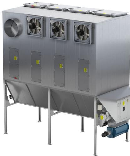
O LBR-C é um filtro de saco com limpeza por ar reverso, avançado, pronto para IIoT, adequado para aplicações de serviço contínuo com elevados caudais de ar e grande carga de poeira. O compartimento do filtro modular pode ser dimensionado para o caudal de ar necessário e módulos adicionais podem ser instalados posteriormente se for necessária capacidade adicional. O filtro LBR é autossustentável com pernas telescópicas para ajuste de altura e é adequado para instalações ao ar livre.
