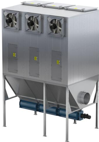
El filtro inteligente LBR-R, preparado IloT, es un filtro de mangas con limpieza por flujo de aire inverso para aplicaciones de uso continuo con volúmenes de aire medio y una gran carga de polvo. La carcasa del filtro modular se puede escalar para el flujo de aire requerido y se pueden instalar módulos adicionales en caso de requerir capacidad adicional.
