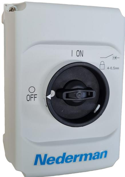
Motor-starter mit Motorschutzschalter für 1-Phasen oder 3-Phasen betriebene Ventilatoren mit Direkteinschaltung. Wenn das Startsignal aktiviert ist, läuft der Ventilator nach einer Spannungsunterbrechung automatisch wieder an. Absperrbarer Schalter im Aubauegehäuse.
