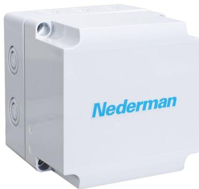
Para arrancar y parar un ventilador centralizado en combinación de varias válvulas motorizadas (los ventiladores de mayor capacidad pueden controlarse a distancia a través de un arrancador o a través de un variador de frecuencia). El interruptor de ventilador incluye protección del motor de los ventiladores. Protección de clase IP66. Bobina de 24 V AC, desde la caja de control o el aspirador
