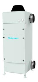
Les filtres NOM sont conçus pour des machines à commande numérique d'acier, pour des machines à laver industrielles, pour du découpage à l'eau. Dans tous les procédés de fabrication de métal générant des brouillards d'huile, ces filtres peuvent être utilisés, montés directement sur les machines ou raccordés à un réseau. Toutes les unités sont munies d'un préssostat pour surveiller l'état du filtre et indiquer quand le filtre doit être nettoyé. Convient aux huiles solubles et huiles entières.
