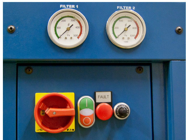
El FilterBench está equipado con manómetros que indican con claridad el momento de reemplazar los filtros.
