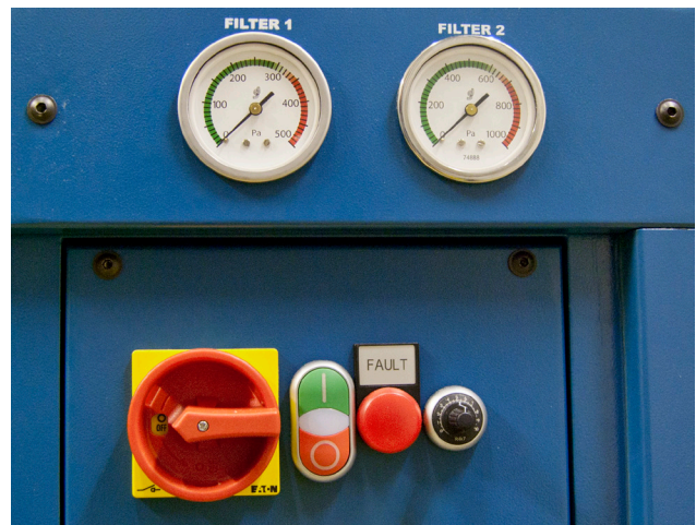
Le FilterBench est muni de manomètre indiquant clairement lorsqu'il est temps de remplacer les filtres.
