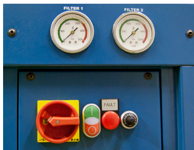
FilterBench jest wyposażony w manometry, które w widoczny sposób informują o konieczności wymiany filtrów.
