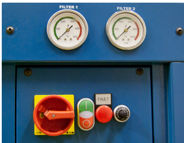
FilterBench är utrustad med tryckmätare som tydligt visar när det är dags att byta filtren.
