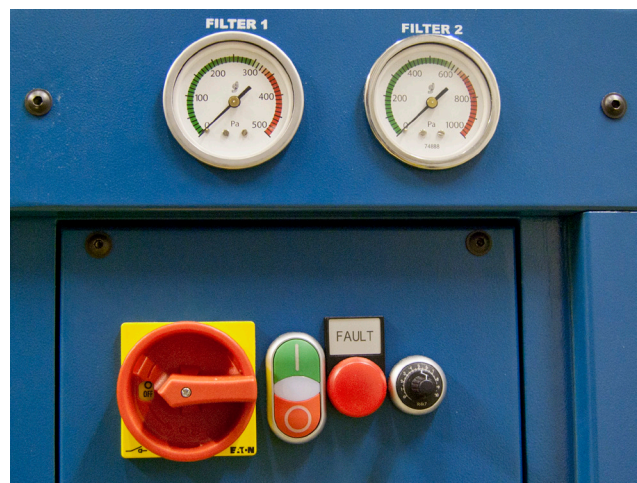
De FilterBench is uitgerust met drukmeters die duidelijk aangeven wanneer het tijd is om de filters te vervangen.
