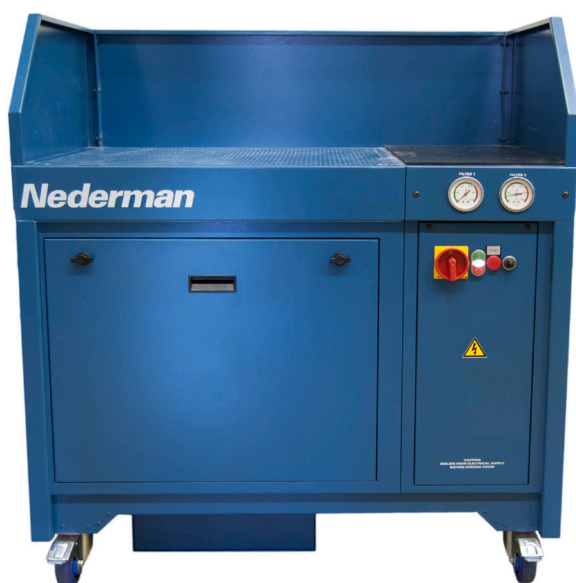
De FilterBench is uitgerust met drukmeters die duidelijk aangeven wanneer het tijd is om de filters te vervangen.
